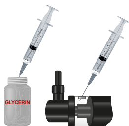
Ricarica del serbatoio
