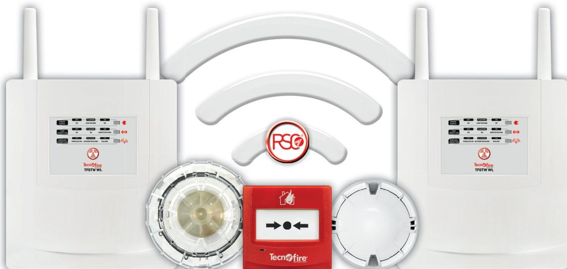
FIREWAVE è un sistema wireless ad alta sensibilità con doppia banda di frequenza (433 MHz e 868 MHz) multicanale. Modulazione digitale FSK. Protocollo di comunicazione radio bidirezionale WL FIRE SPEED.
