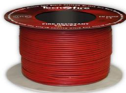
Cables con conductores flexibles de cobre rojo. Recubrimiento rojo de material termoplástico con compuesto retardante de llama, libre de halógenos con baja emisión de humos LSZH. Temperatura de funcionamiento -40°C ... +75°C. Temperatura máxima de servicio -40°C... +90°C, aislante XLPE (polietileno reticulado mineral). Tensión de funcionamiento 100/100V. Tensión de prueba 2000V.
