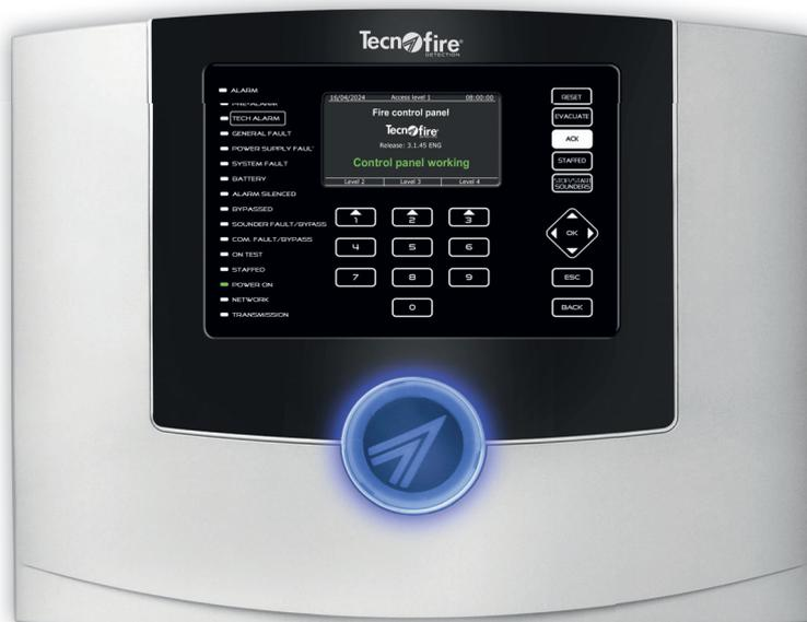
Central de detección de incendios direccionable. Equipada con 4 bucles de detección. Cada bucle de detección puede controlar: 199 detectores y 99 módulos. 2 buses serie RS485 para conectar dispositivos de expansión, hasta 16 dispositivos a elegir entre: paneles repetidores y/o dispositivos de telecomunicaciones. La central TFA4-1192 puede formar parte de una red de centrales Tecnofire.
